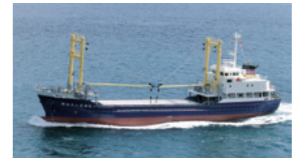
デリックを持つ一般貨物船。荷役設備の設置されていない港への輸送や、復興資材などの輸送にも使われている。
