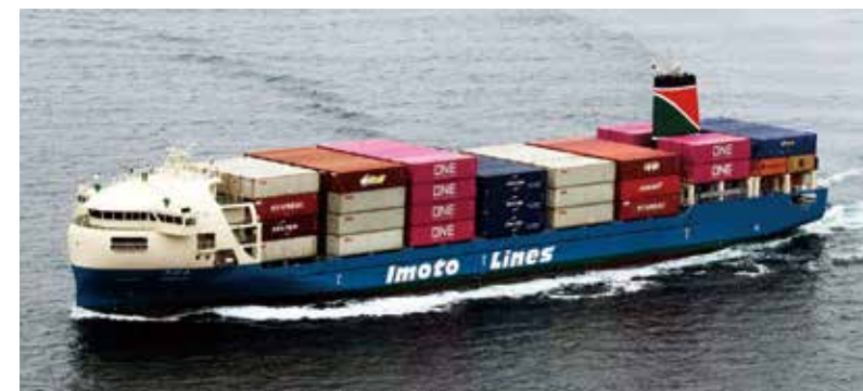
RORO船と並んでモーダルシフトの担い手のコンテナ船。最新鋭のこの船は、2021年コンテナを670本積載(うち冷凍コンテナ110本)し、16日間で京浜～阪神～北九州航路を航行する。 風圧抵抗が少ない球状船首と垂直船首を組み合わせる省エネ効果を向上。主機関はフル電子制御エンジンを搭載し、低燃費と低負荷での連続航行を可能にして、CO 2 を削減。特殊な形状の2枚舵のゲートラダーをプロペラの両側に配置し省エネ効果、振動や騒音の低減、離着岸性能を向上させている。居住区は、船員の居室定員11名に対し乗船研修のための10室を追加し21室を設け、各船員室にはシャワー、トイレを完備し大型実習室、女性専用区画も設置して、若年船員の教育船としての機能も備えている。 7,432総トン、6,887重量トン、LBD: 136.3×21.0×6.0m
