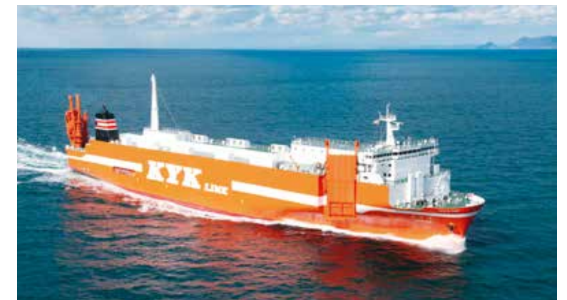
モーダルシフトの担い手のRORO船。本船は旧運航船と比べ、全長12m、幅3m程長い大型船型とするとともに、フィンスタビライザー・ビルジキールの大型化によって船体動揺を減じることにより、積載貨物のより一層の安全輸送が可能となっています。 また、省エネにも配慮した設計となっており、電子制御式低速ディーゼル主機関、バルブ付リアクション舵高効率可変ピッチプロペラ等の省エネ機器を装備しています。 なお、本船は、国土交通省が認定する「内航船省エネ格付け制度」で、最高ランクの【★★★★★（EEDI）】に格付されています。 11,229総トン 6,100重量トン数 LBD（m）179.9×27.0×6.80
